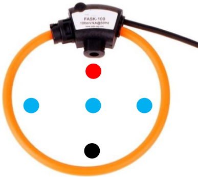
Abbildung 5: Primärleiterposition mit den typischen Fehlerwerten
